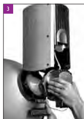
ถอดตัวตัดไฟหลอดออกจากตัวสะท้อนแสง
